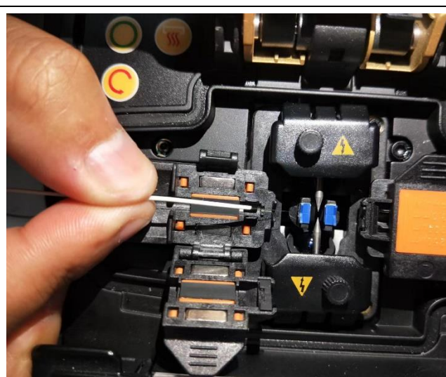
Pulire il V-groove con una fibra tagliata
