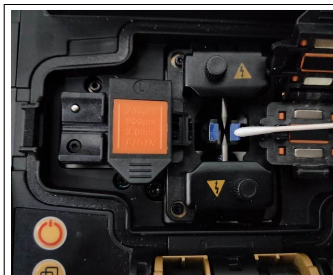
Pulire il V-groove con un bastoncino imbevuto di alcol
