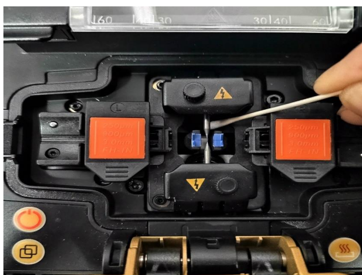
Pulire le lenti delle telecamere con un bastoncino imbevuto di alcol
